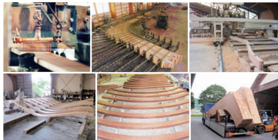
自社開発の専用ラインによりラミナ製造、接着剤塗布、湾曲材油圧プレスによる圧縮。
